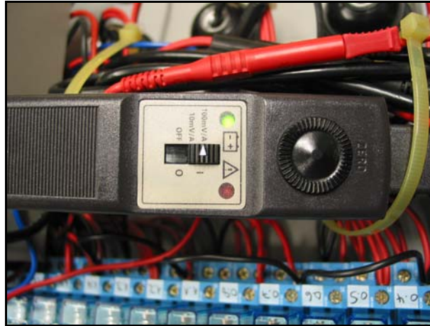
Abb 10 : Installation Einschalten und Abgleich der Stromzange
